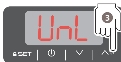
Tastatur freischalten unlocking the keypad
