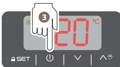
Einschalten/Ausschalten der Steuertafel activation/deactivation of the control panel
