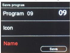
Den Namen des Programms einstellen, indem man den Knopf dreht und den gewählten Buchstaben durch Druck des Knopfs 16 bestätigt. Nach der Einstellung des Namens des Programms "OK" wählen und durch Druck des Knopfs 16bestätigen.
