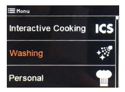
Den Knopf **16**drehen, die gewünschte Reinigung wählen, die auf dem Display **15** angezeigt wird und den Start durch Druck des Knopfs **16**bestätigen.
