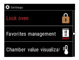
Das Passwort für die Sperre durch Drehen des Knopfes **16** eingeben und durch Drehen des Knopfes **16** bestätigen.
