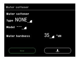
Durch Drehen des Knopfes **16** den Typ und das Modell des Enthärters auswählen:
