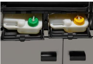
Die Kartusche wieder an der vorgesehenen Stelle einsetzen und die Klappe sowie die Tür des Ofens schließen.
