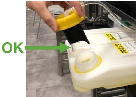
Den Deckel mit dem Absaugsystem einsetzen (**GELB** für das Reinigungsmittel **COMBICLEAN** und **GRÜN** für den Entkalker **CALFREE**) und dabei darauf achten, dass der transparente Schlauch zum Absaugen des Reinigungsmittels wie in der Abbildung dargestellt zur Vorderseite der Kartusche hin ausgerichtet ist.
