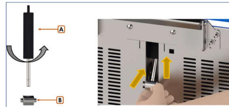
8) Setzen Sie die Abdeckung wieder ein, indem Sie sie nach unten drücken.
