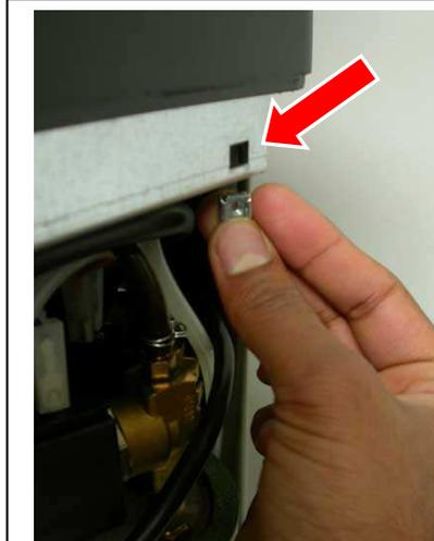
Legen Sie die im Lieferumfang enthaltene Käfigmutter ins Gehäuse ein
