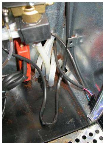
Ziehen Sie das Kabel für die LEDs der Einheit instant durch den Schlitz durch und legen Sie es in den freien Anschluss (s. Pfeil).
