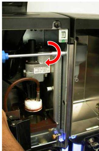
Schrauben Sie durch den Steckschlüssel die M4x20-Schraube, um die Einheit instant zur Kaffeemaschine zu verbinden
