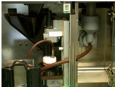
Verbinden Sie den Braunsilikonschlauch an den Mischerauslauf, und dann bypass die Schottwand
