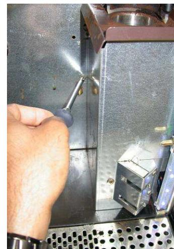
Montieren Sie das Kaffeegruppe-Schutzgehäuse wieder und schrauben Sie es durch die 2 M4-Schrauben
