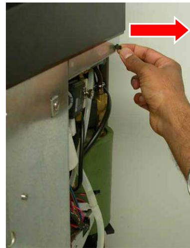
Entfernen Sie die Klammer aus dem Gehäuse
