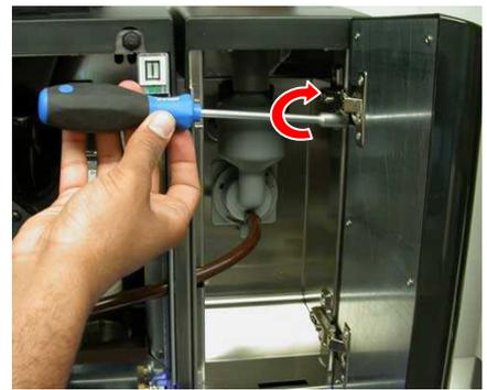
Befestigen Sie die Seitenwand durch M4-Mutter und 7-mm-Steckschlüssel
