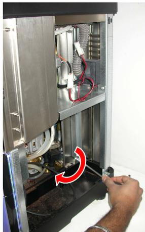
Schrauben Sie die 3. M4x20-Schraube durch den 7-mm-Steckschlüssel
