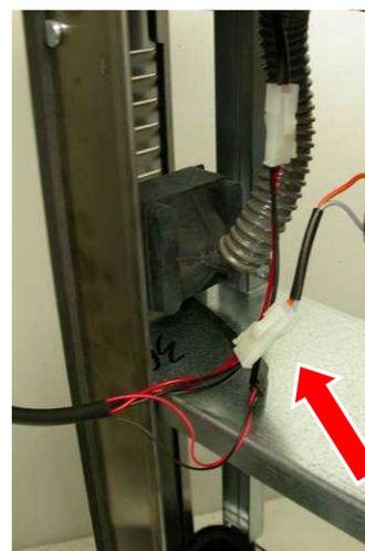
Verbinden Sie das Kabel in der Steuereinheit zum CN32-Anschluss
